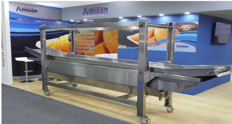
La línea de freidoras continuas **FRAYMAX** es una de las mejores alternativas para el proceso continuo de fritura de empanadas. El modelo Frymax-4000 se llena con 260 litros de aceite y permite frituras de hasta de 400Kg/hora ( 4000 empanadas por hora). Su sistema único de barrido y recolección de boronas contribuye a la durabilidad y rendimiento del aceite.
